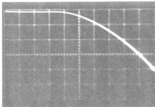
**Gambar 11.8** : Kurva transfer karakteristik dari display oscilloscope
