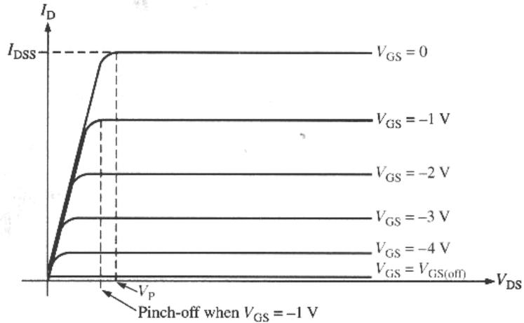
**Gambar 11.2 :** Pinch-off terjadi pada nilai  $V_{DS}$  terendah saat arus drain mulai konstan
