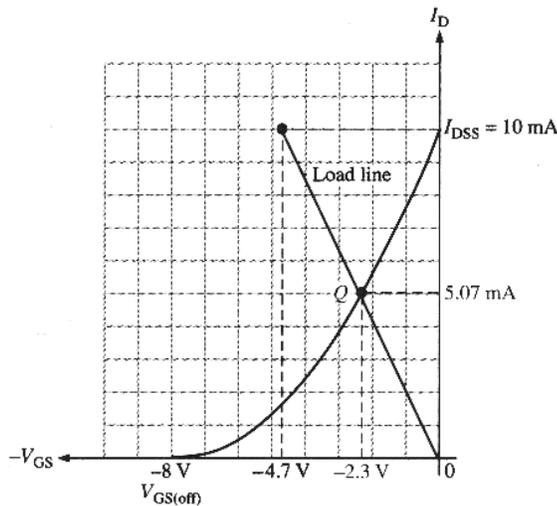
**Gambar 12.4** : Titik kerja dari rangkaian gambar 12.2 secara grafis
