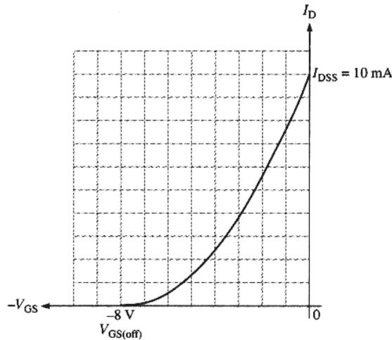
**Gambar 12.3** : Kurva transfer karakteristik dari rangkaian gambar 12.2.
